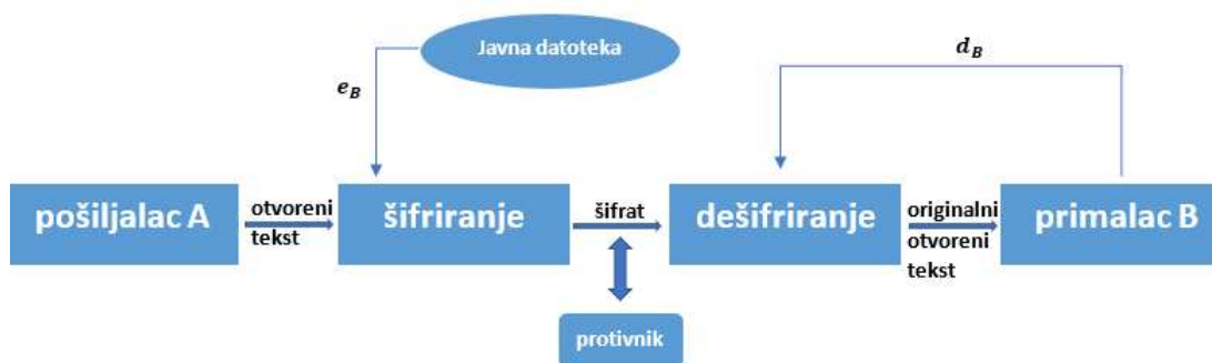
Slika 2.1: Shematski prikaz kriptografije javnog ključa
