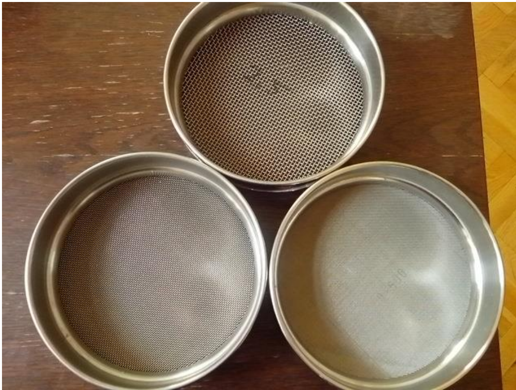
Slika9. Sita za prosijavanje uzoraka (veličine pora 2.5, 1.0, 0.315 milimetara)
