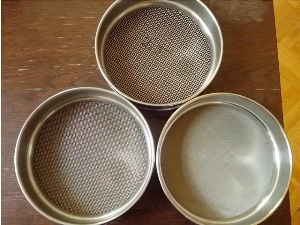
Slika9. Sita za prosijavanje uzoraka (veličine pora 2.5, 1.0, 0.315 milimetara)
