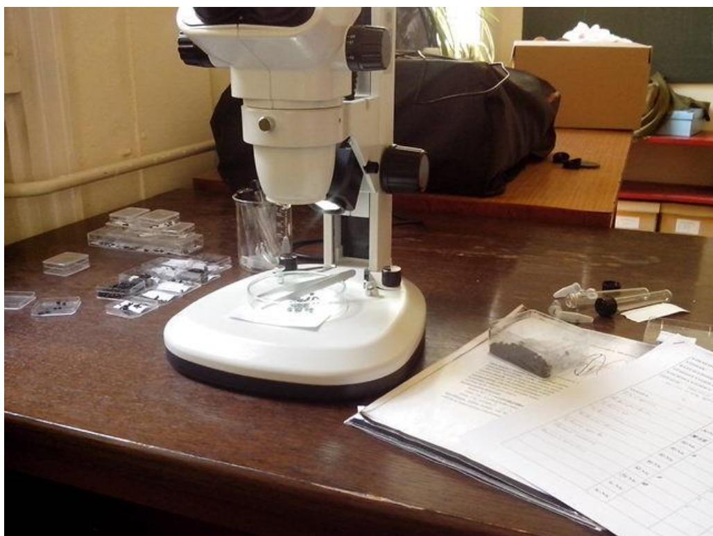
**Slika10.** Binokularna lupa za izloaciju biljnog materijala i determinaciju
