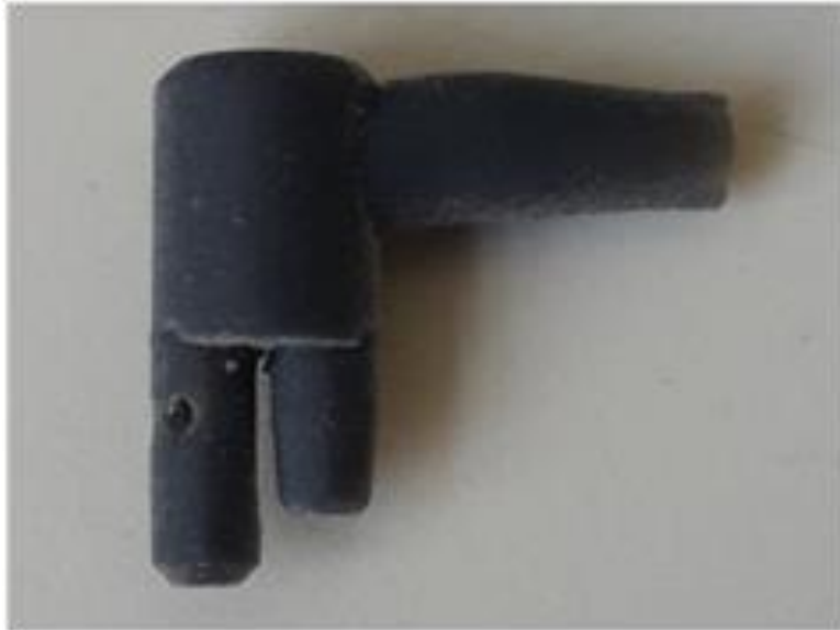
Slika 41. Kućište sonde za mjerenje temperature
