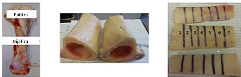
Slika 31. Primjer pripreme histoloških preparata prilikom ispitivanja termičkih oštećenja kosti uslijed bušenja medicinskim svrdlom ( Prilagođeno prema: Lughmani i sur., 2015. )
