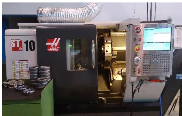
Slika 33. CNC tokarilica ST-10. Proizvođač: HAAS – USA, Instrumetaria d.d.
