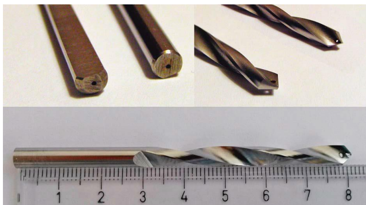
Slika 26. Primjer medicinskoga svrdla s unutarnjim hlađenjem
