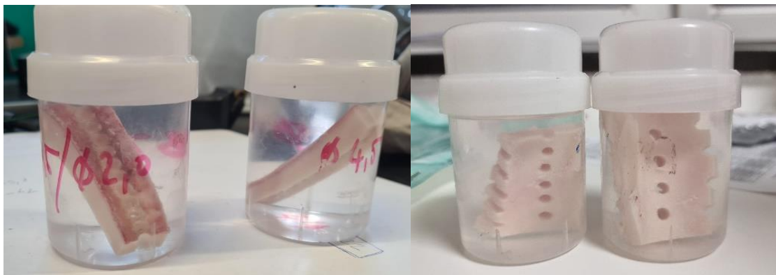
Slika 44. Izrezani uzorci goveđih kosti s izbušenim provrtima u otopinu 10 % puferiranog formalina
