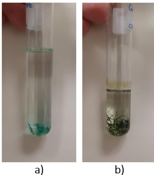
Slika 28. Jedinični kristali koordinacijskih polimera bakra(II): a) [\text{CuCl}_2(3\text{-NO}_2\text{py})_2]_n ( 1 ), b) [\text{CuBr}_2(3\text{-NO}_2\text{py})_2]_n ( 2 ).
