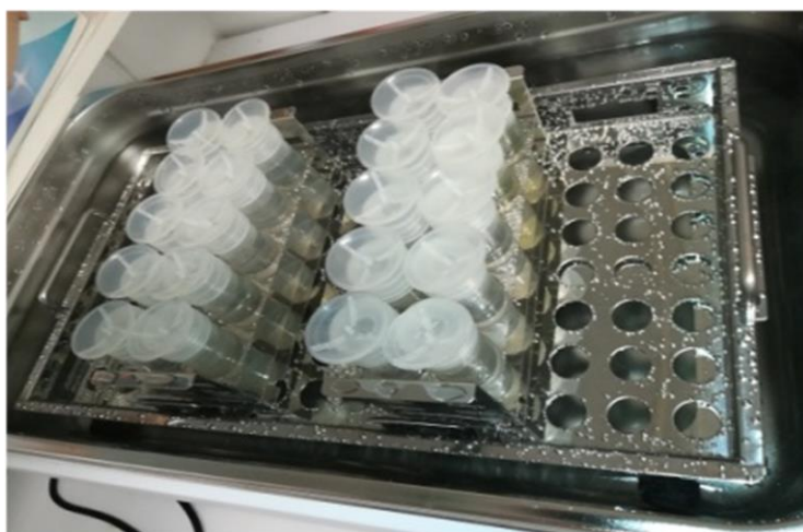
Slika 4. Vodena kupelj za redukcija selenija
