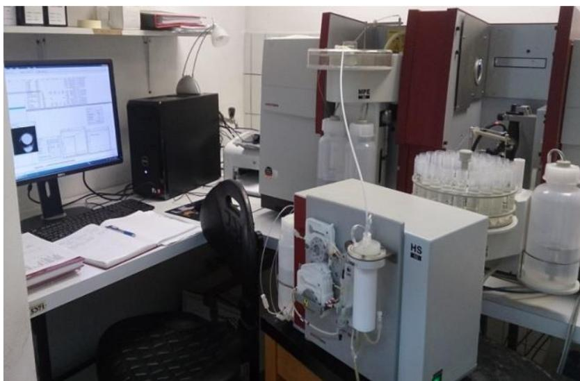
Slika 1. AAS 700 P sa HG sustavom, model HS 60
