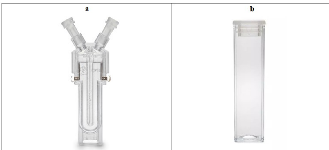
Slika 22: Kiveta za mjerenje zeta potencijala (a) i kiveta za mjerenje veličine čestica (b) (preuzeto i prilagođeno prema 48)
