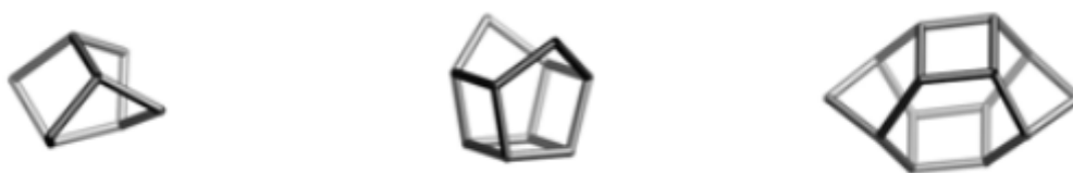
Slika 4. Gradivne jedinice zeolita strukturnog tipa beta (redom mor (t-tes ), bea i mtw (t-mtw )) 7
