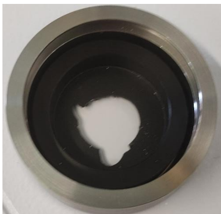
Slika 22 Stalac na kojem se učvrstio meteorit
