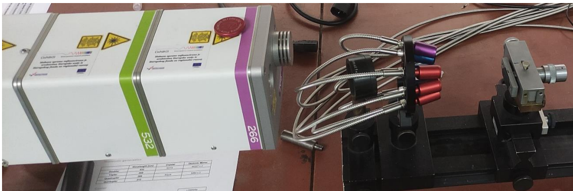
Slika 16 Bliži prikaz postava. Bolje vidljivi stalak, optički sustav za prikupljanje svjetlosti plazme (8 kanalni) sa pripadnim optičkim kablovima koji dalje vode do spektroskopa i harmonički moduli.
