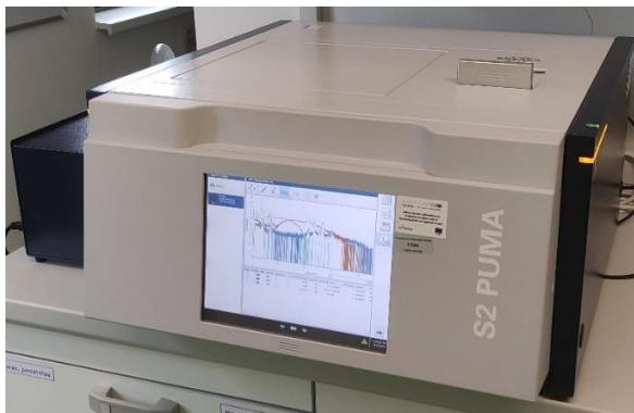
*Slika 20 XRF mjerni postav, Bruker S2 PUMA.*
