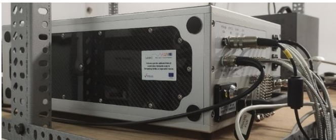
Slika 17 Osam kanalni spektroskop proizvođača Avantes pod kodnim imenom AvaSpec-ULS4096CL-EVO.
