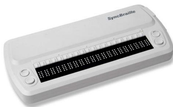
Slika 6: SyncBraille - najmanji Brailleev redak
