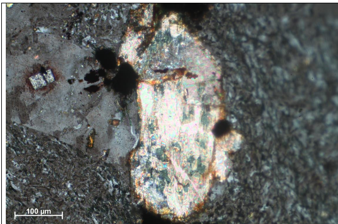
Slika 21. Kloritizirani biotit sa kalcitom, na lijevoj je strani vidljivo idiomorfno mineralno zrno sa okolnim rubom unutar albite, N+
