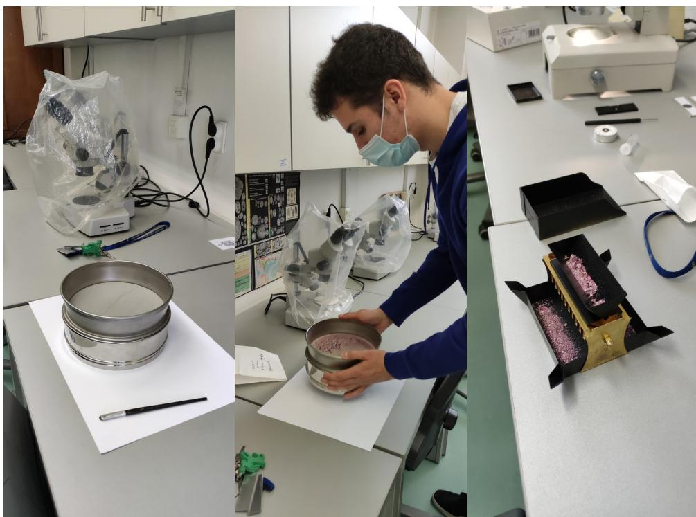
Slika 2. Potreban pribor za suho prosijavanje (dva sita, promjera rupica(63 i 125 µm)), prosijavanje i standardizacija uzorka uz korištenje mikrosplitera (Izvor: vlastita fotografija)
