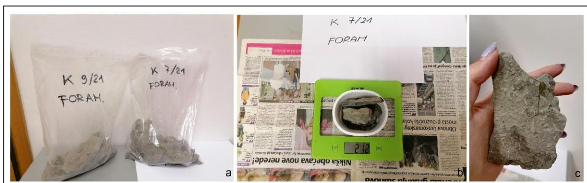
Slika 8. a) Uzorci litificiranih laporanja u plastičnim vrećicama; b) Vaganje uzorka K-7 za potrebe usitnjavanja; c) Uzorak litificiranog laporanja užet za laboratorijska istraživanja
