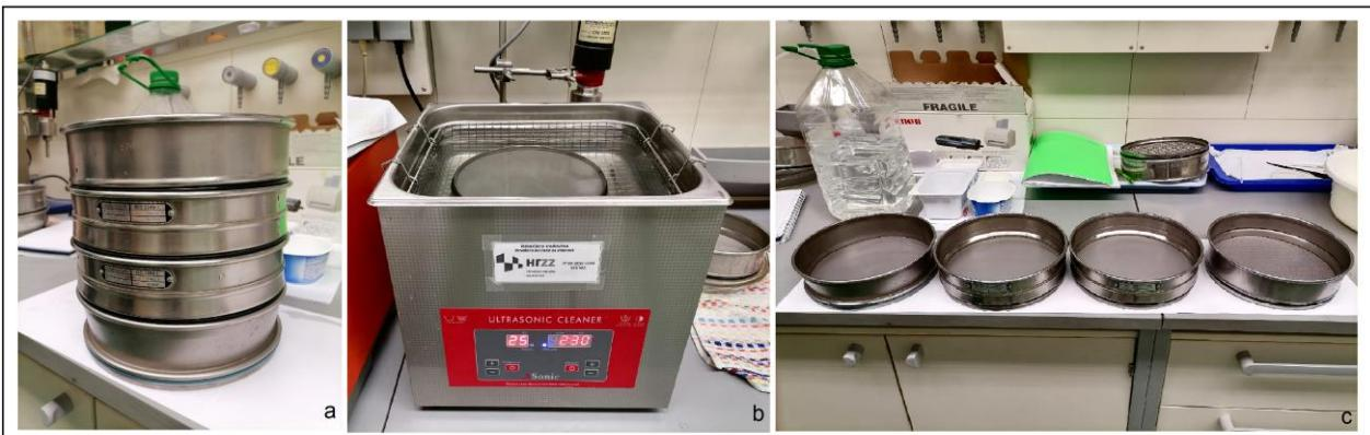
Slika 10: a) Sita poredana od najmanjeg promjera ka najvećem (63, 125, 250, 500 mikrometara); b) Ultrazvučna/ultrasonična kadica; c) Sita pojedinačno.
