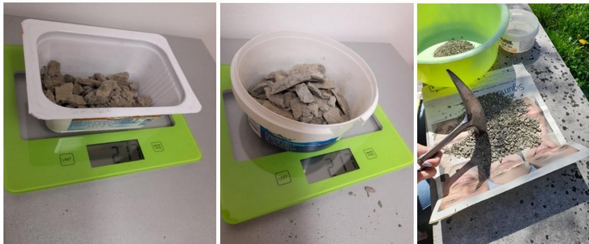
Slika 8.a) Vaganje uzorka i b) njegovo mehaničko usitnjavanje
