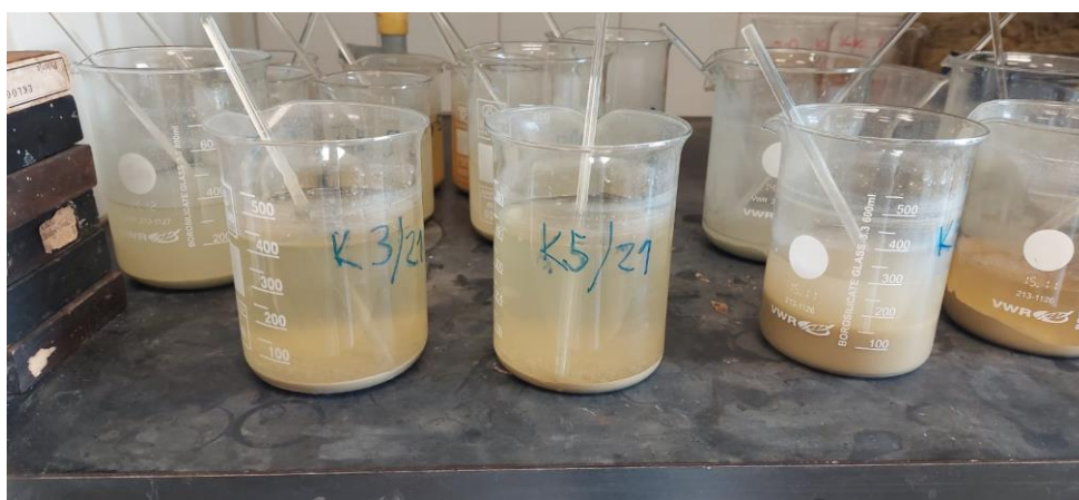
Slika 8. Uklanjanje karbonatne faze
