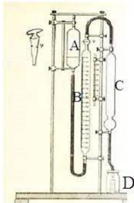
**Slika 6.** Dijelovi Scheiblerovog kalcimетra
