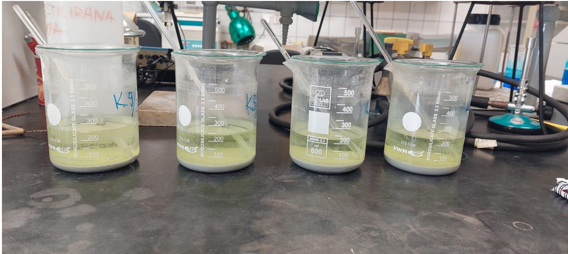
Slika 10. Uklanjanje Fe-Al-Mn oksida/hidroksida Tammovim reagensom
