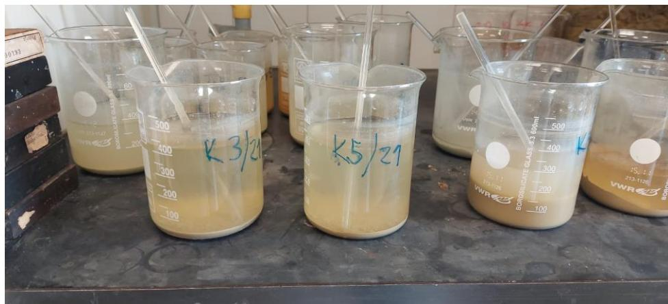
Slika 8. Uklanjanje karbonatne faze
