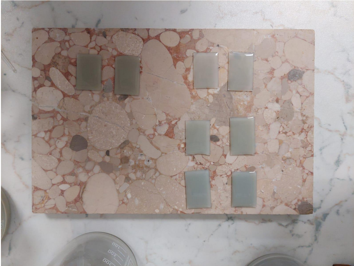
Slika 13. Priprema orijentiranih preparata nakapavanjem
