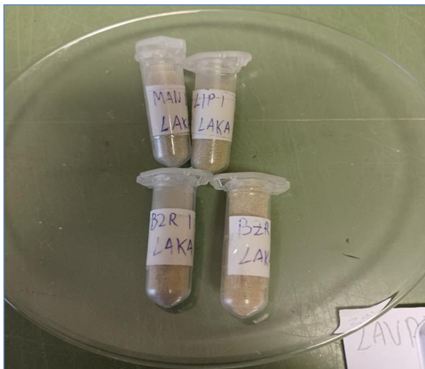
Slika 12. Prikaz dobivene lake frakcije procesom filtracije
