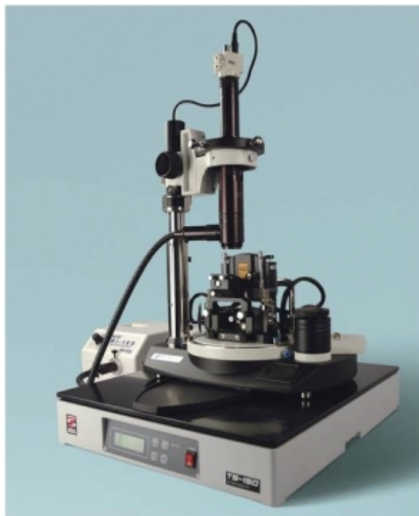
Slika 5.12: AFM mikroskop NT-MDT Spectrum Instruments NTEGRA Prima, Laboratorija za poluvodiče Instituta Ruđer Bošković, korišten u našim mjerenjima. Fotografija preuzeta s web stranice https://www.croris.hr/oprema/oprema/327
