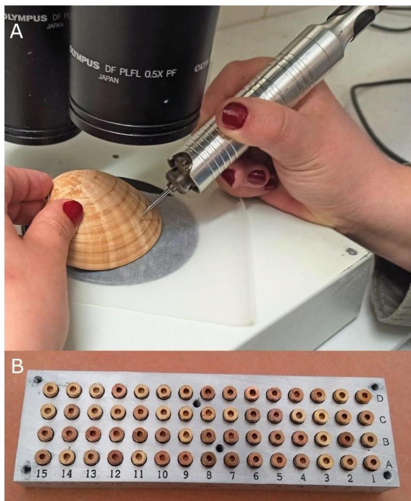
Slika 3.3.2. A) Ručno mikromljevanje pomoću Dremel® Fortiflex bušilice; B) postolje za kositrene ampulice u koje se stavlja prikupljeni ljuštorni materijal.
