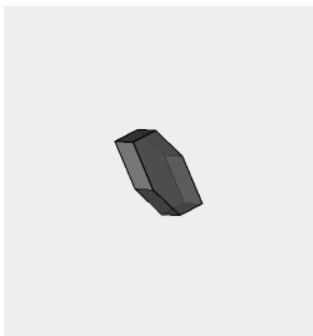
Slika 20 Paralelnoperspektivni crtež kristala uricita (Ringertz, 1966)
