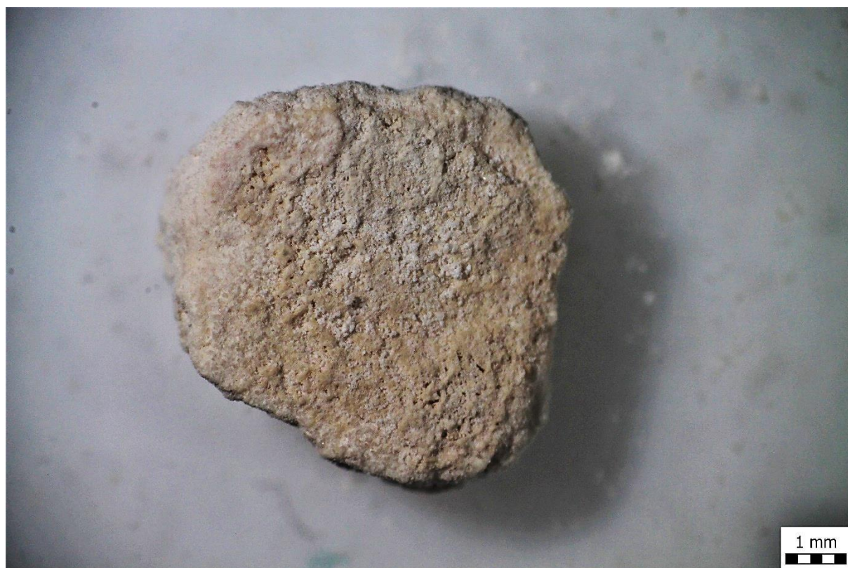
Slika 60 Rupičavost na površini fragmenta kamenca Uzorka 11
