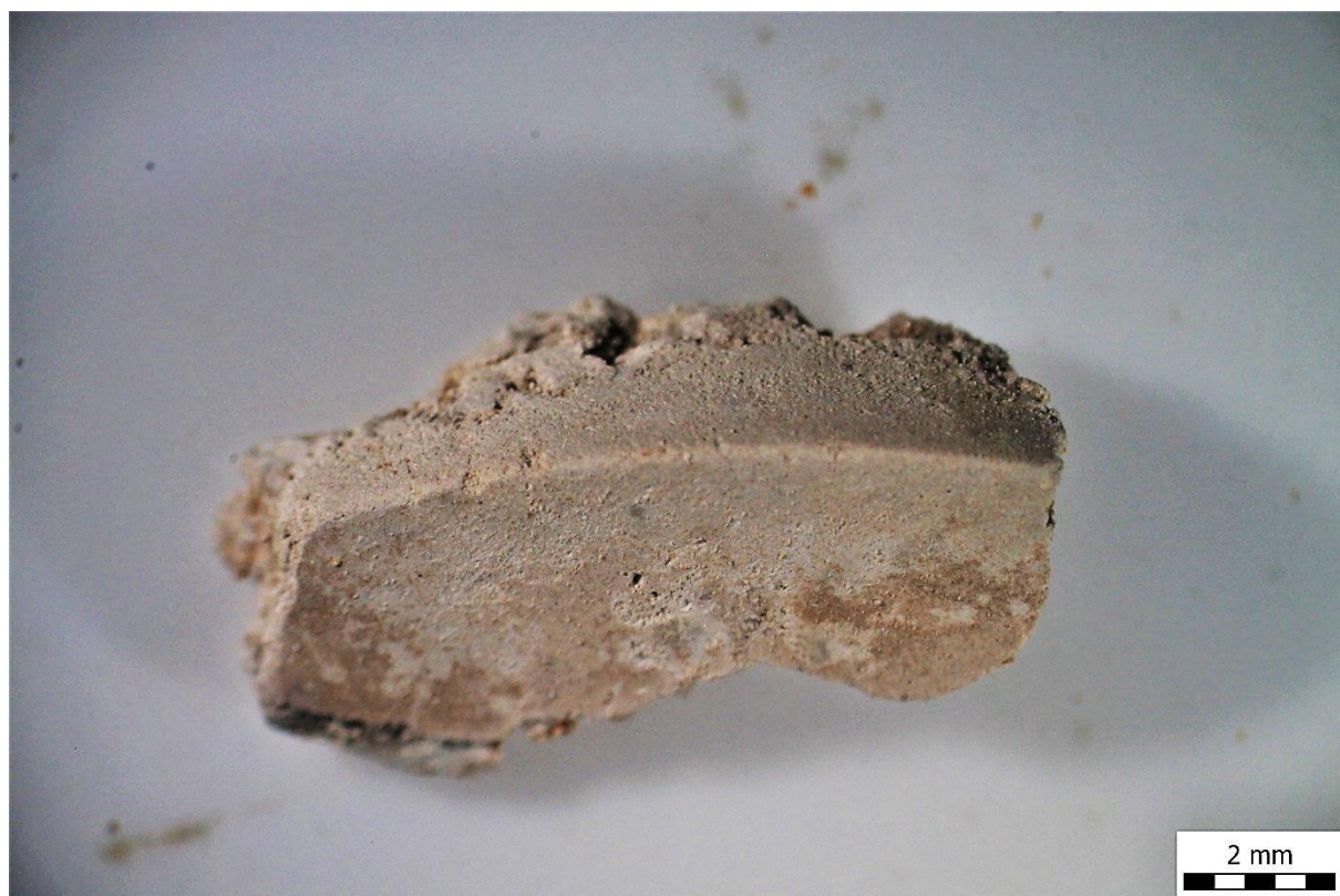
Slika 45 Oštri bridovi na gornjoj strani kamenca Uzorka 6
