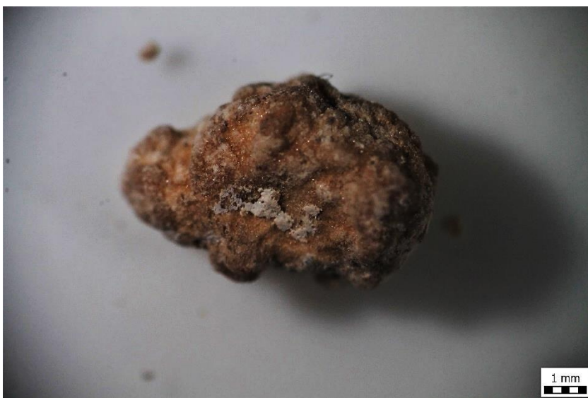
Slika 29 Bubrežasta tekstura i bijela "prevlaka" Uzorka 1
