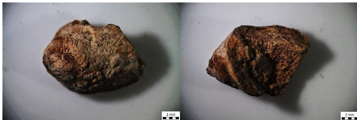
Slika 37 Usporedba vanjskog dijela sa bubrežastom teksturom i unutrašnjeg dijela sa zrnatom teksturom Uzorka 4
