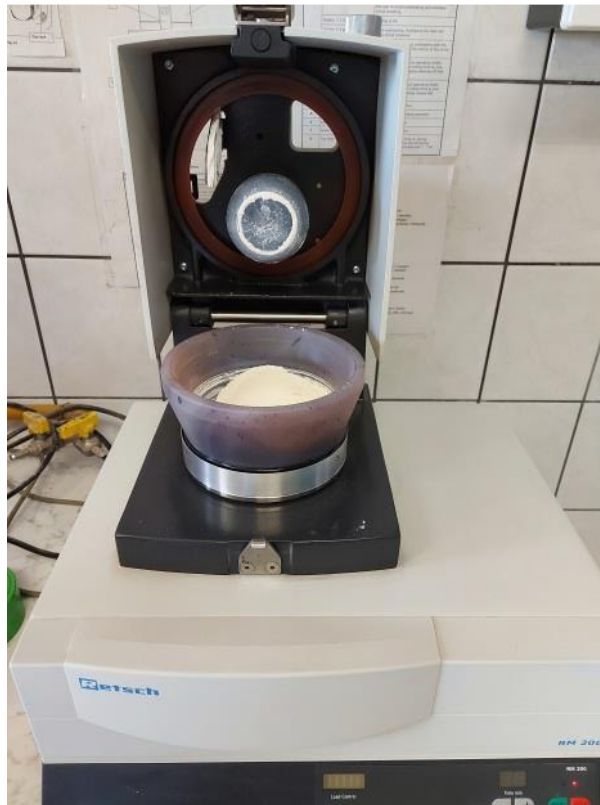
Slika 15: Priprema uzorka za analizu pomoću mehaničkog tarionika
