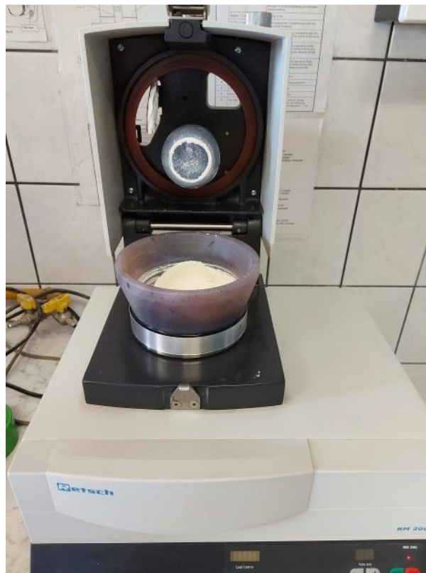
Slika 15: Priprema uzorka za analizu pomoću mehaničkog tarionika
