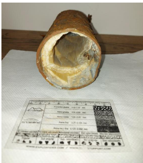
Slika 10: Željezna cijev s vidljivim uzorkom Slika 11: Uzorak C2 izvađen iz cijevi
