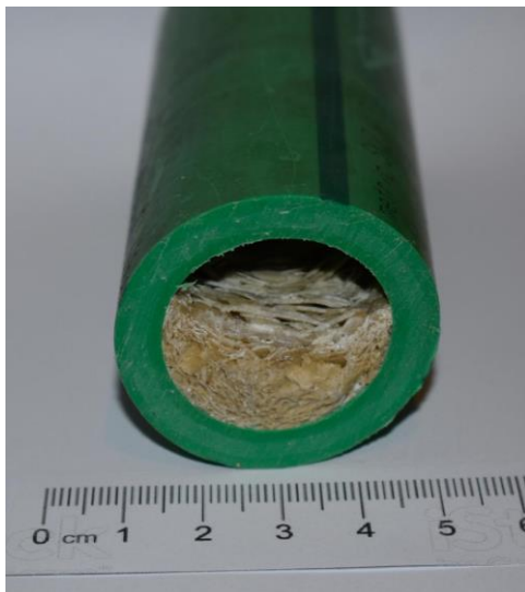
Slika 8: Plastična cijev s vidljivim uzorkom Slika 9: Uzorak C1 izvađen iz cijevi
