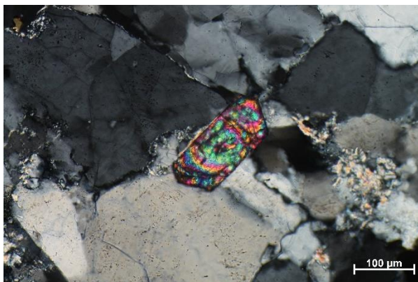
Slika 22: Mikrofotografija cirkona s uključenim analizatorom (N+). Paralelno potamnjenje (lijevo); žive interferencijske boje u položaju maksimalne rasvjete (desno). Grafičko mjerilo = 100 μm.
