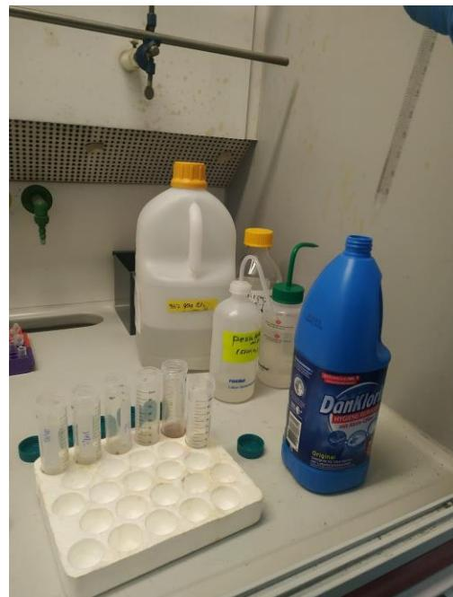
Slika 6. Uzorci otopljeni u destiliranoj vodi te  $\text{NaClO}$
