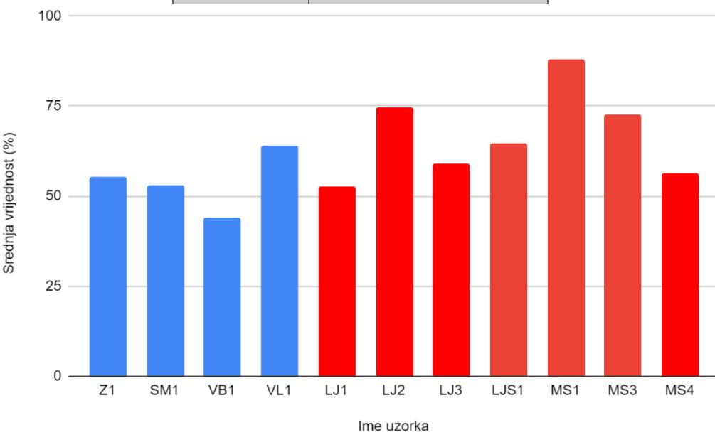
Slika 34. Prikaz udjela CaCO<sub>3</sub> u pojedinim uzorcima. Plavom bojom označeni su uzorci sa otoka Paga, a crvenom uzorci iz područja kopna sjeverne Dalmacije.
