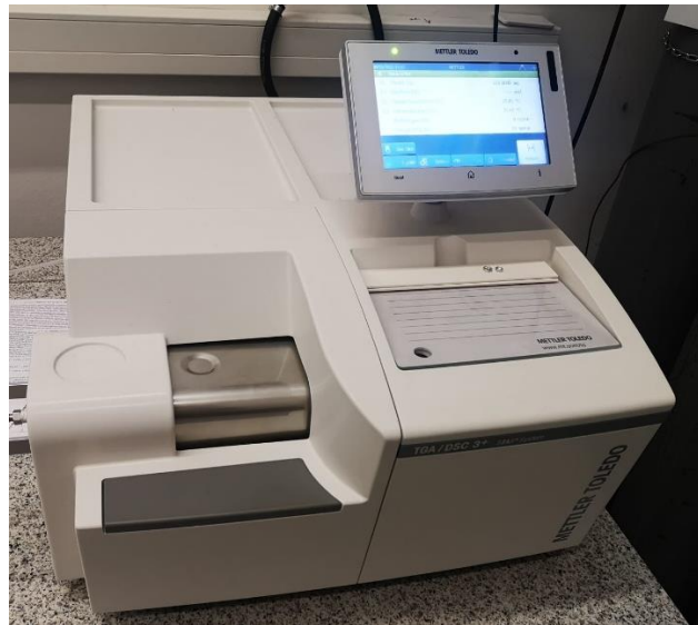
Slika 14. Uređaj za termogravimetrijsku analizu Mettler-Toledo TGA/DSC 3+
