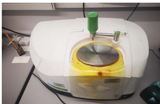
Slika 13. SpectrumTwo FT-IR spektrometar s dijamantnim ATR dodatkom
