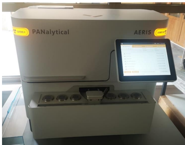
Slika 12. Difraktometar za polikristalne uzorke Malvern Panalytical AERIS
