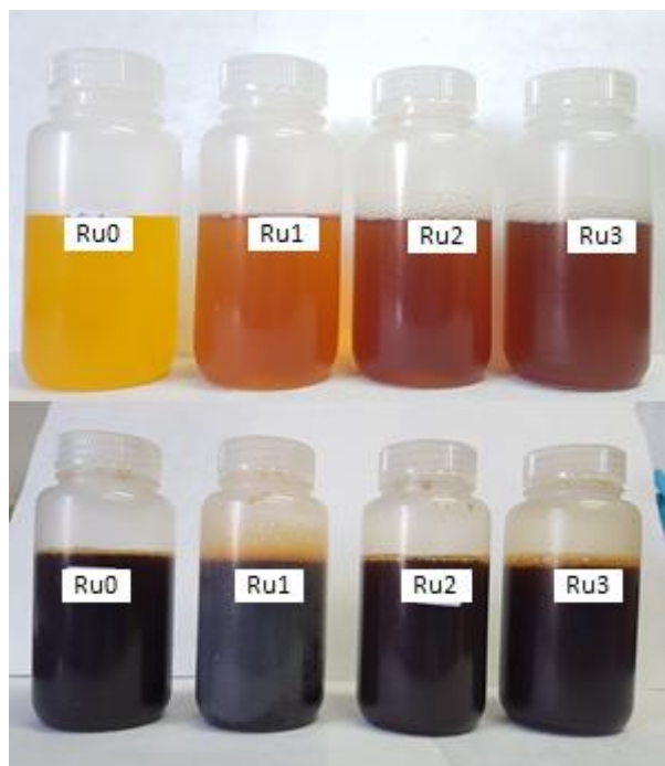
Slika D1. Fotografije reakcijskih smjesa prilikom sinteze uzoraka hematita dopiranih ionima \text{Ru}^{3+} prije (iznad) i nakon (ispod) dodavanja otopine TMAH.
