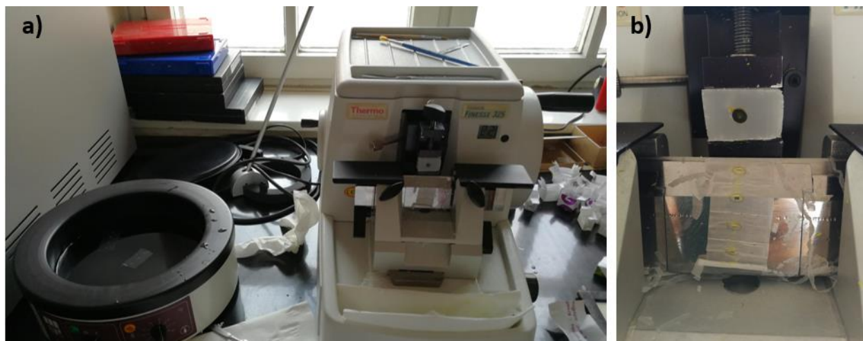
Slika 18. a) rezanje blokova uz pomoć mikrotoma (desno) i vodena kupelj (lijevo); b) dobiveni rezovi
