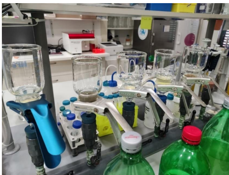
Slika 8: Membranska filtracija uzoraka. Autorska fotografija
