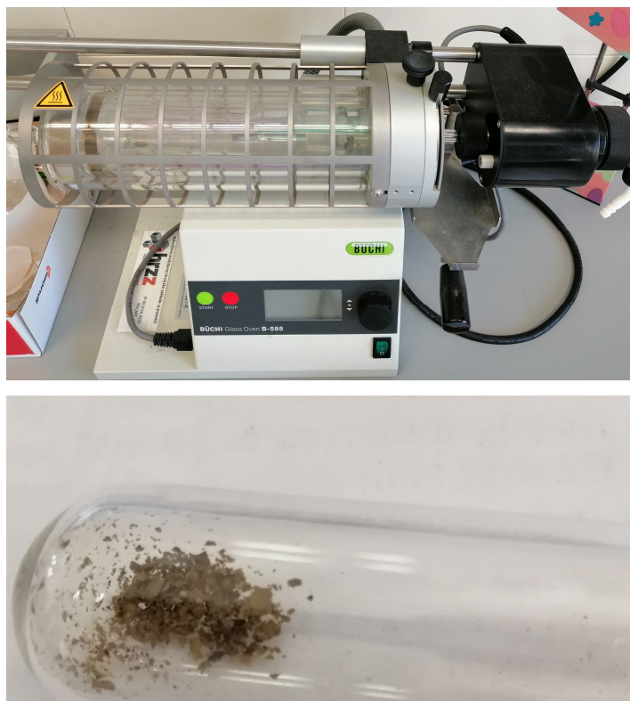
Slika 21. Prikaz promjene boje i strukture mononuklearnog kompleksnog spoja [\text{MoO}_2(\text{L}^2)(\text{H}_2\text{O})] u polinuklearni kompleksni spoj [\text{MoO}_2(\text{L}^2)]_n pod utjecajem visoke temperature u staklenoj peći
