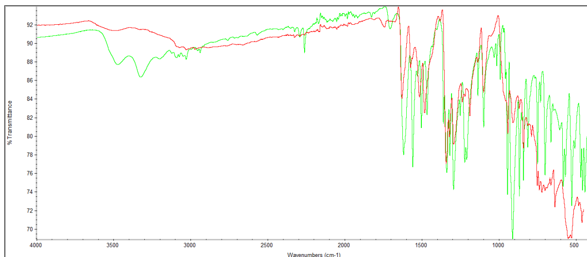
Slika D15. Usporedba IR spektara mononuklearnog kompleksnog spoja [\text{MoO}_2(\text{L}^2)(\text{H}_2\text{O})] \cdot \text{MeCN} (zeleno) i polinuklearnog kompleksnog spoja [\text{MoO}_2(\text{L}^2)]_n (crveno)
