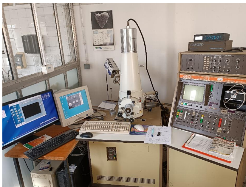
Slika 8. Skenirajući elektronski mikroskop (SEM), Jeol JSM-35 CF (Izvor: Petra Hus).
