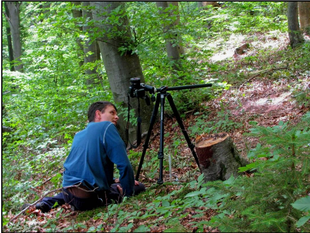
Slika 2: fotoaparat za snimanje hemisfernih fotografija na tronošću.
