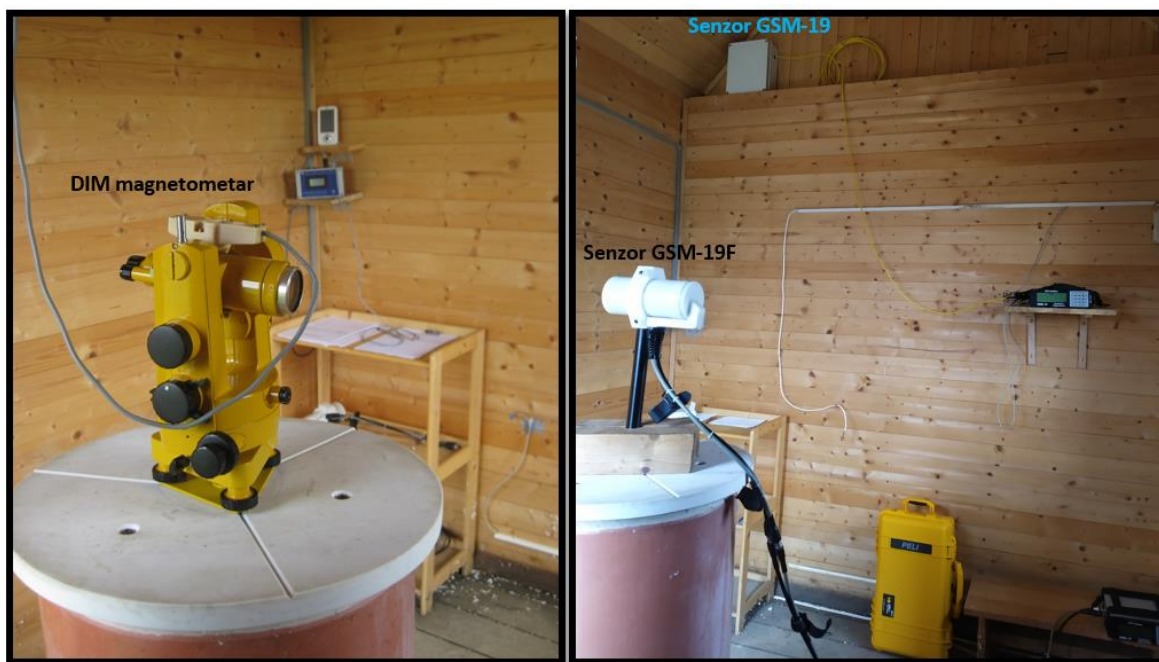
Slika 1.5 – Lijevo: Deklinacijsko-Inklinacijski magnetometar na pilaru u A kući. Desno: Mjerenja totalnog intenziteta F u A kući. Senzor GSM-19 magnetometra (u plastičnoj kutiji) permanentno mjeri F na udaljenosti od 2,5 metra od A pilara. Senzor GSM-19F magnetometra koji povremeno mjeri na referentnom A pilaru.
