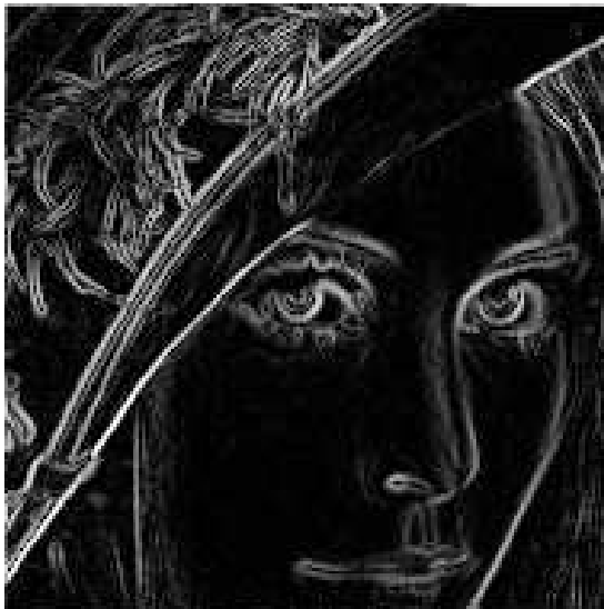
Slika 2.16: Slika gradijenta nakon normaliziranja i povećanja kontrasta funkcijom g_{0.01}
