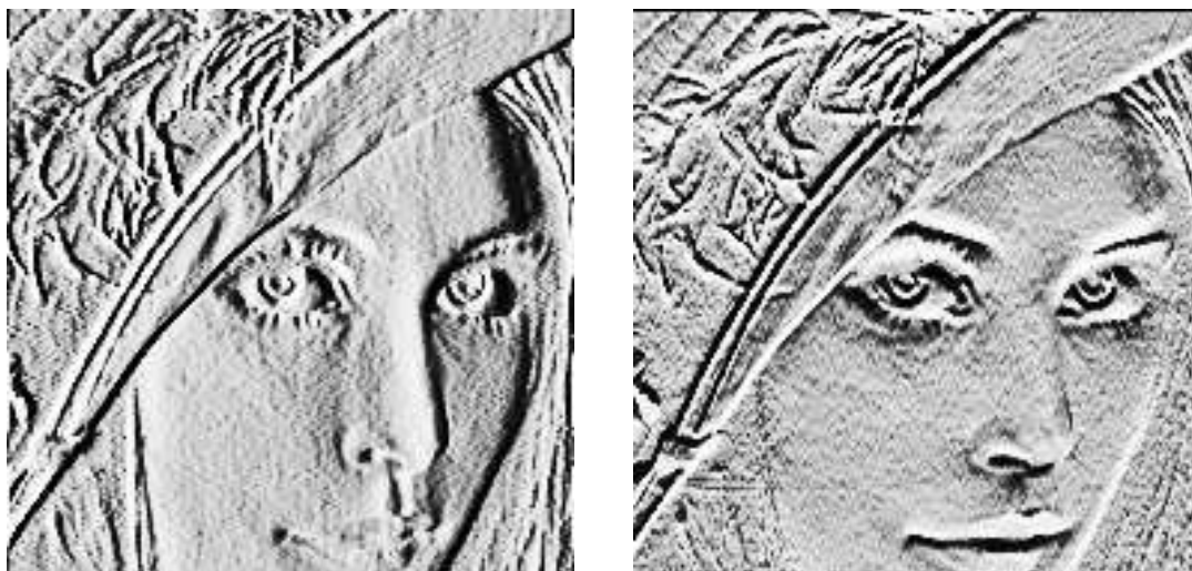
Slika 2.14: Parcijalne derivacije prvog reda po x i y . Na obje slike su vrijednosti normalizirane i kontrast povećan
