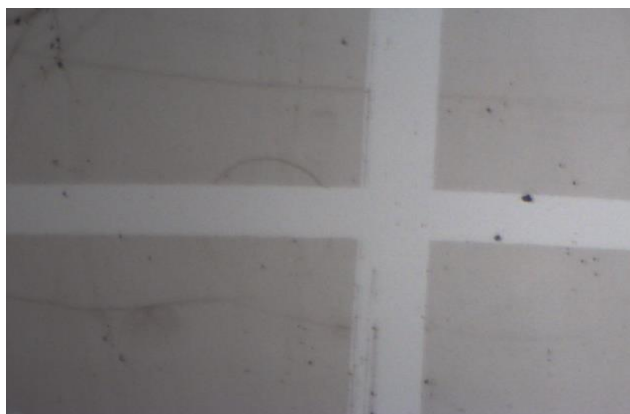
Slika 50. 500 \times 400 \mu\text{m}^2 mikroskopska slika zareza na PEM-u s lizozimom adsorbiranim na terminirajući sloj PAA ((CS-PAA) 5 -Lys)
