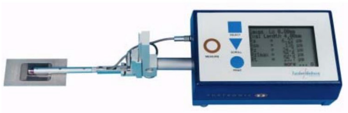
Slika 40. Profilometar Taylor Hobson Precision, Surtronic 25 France, 2010. Preuzeto iz (54)
