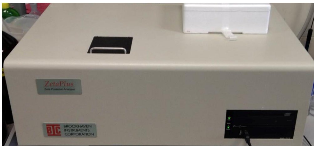
Slika 36. Instrument za mjerenje dinamičkog i elektroforetskog raspršenja svjetlosti (Brookhaven 90 Plus Particle Size Analyzer i Zeta Potential Analyzer, Brookhaven Instruments Corporation)
