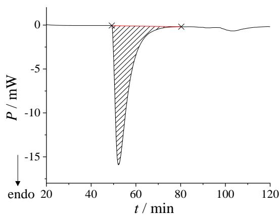
**Slika 57.** Termogram formiranja smjese metastabilne tekućine (benzofenona i difenilamina) i krutine (difenilamina) pri  $25^\circ\text{C}$ . Početni molarni omjer reaktanata bio je ( $n(\text{Dpa}) : n(\text{Bzp}) = 4,89 : 1$ ). Reakcija je provedena u Setaram-Calvetovom kalorimetru.
