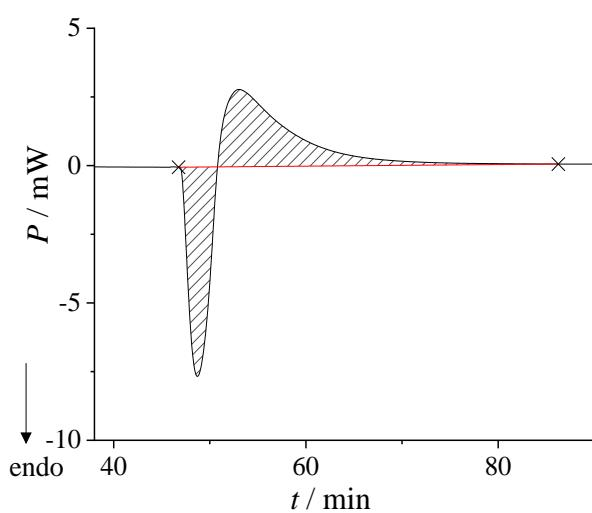
**Slika 59.** Termogram procesa klicom potpomognute kokristalizacije benzofenona i difenilamina ( $m(\text{Dpa}) = 27,91 \text{ mg}$ ) u molarnom omjeru ( $n(\text{Bzp}) / n(\text{Dpa}) = 1 : 1$ ) pri  $25^\circ\text{C}$ . Pokus je proveden u Setaram-Calvetovom kalorimetru.
