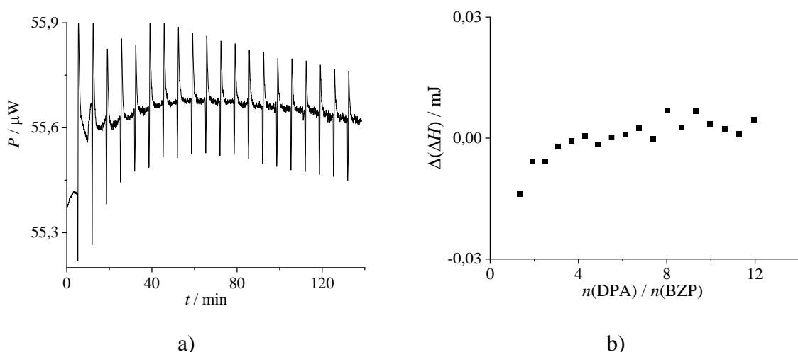
**Slika 56.** a) Mikrokalorimetrijska titracija benzofenona ( $c = 5.40 \times 10^{-4} \text{ mol dm}^{-3}$ ,  $V = 1.43 \text{ ml}$ ) s difenilaminom ( $c = 2.895 \times 10^{-2} \text{ mol dm}^{-3}$ ) u acetonitrilu pri  $25^\circ\text{C}$  b) Ovisnost suksesivne promjene entalpije o množinskom omjeru reaktanata  $n(\text{Dpa}) / n(\text{Bzp})$ . Vrijednosti su korigirane za entalpije razrjeđenja.
