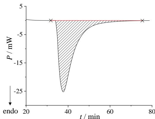
**Slika 58.** Termogram procesa formiranja metastabilne tekućine kokristala benzofenona i difenilamina u molarnom omjeru ( $n(\text{Bzp}) : n(\text{Dpa}) = 1 : 1$ ). Reakcija je provedena u Setaram-Calvetovom kalorimetru.
