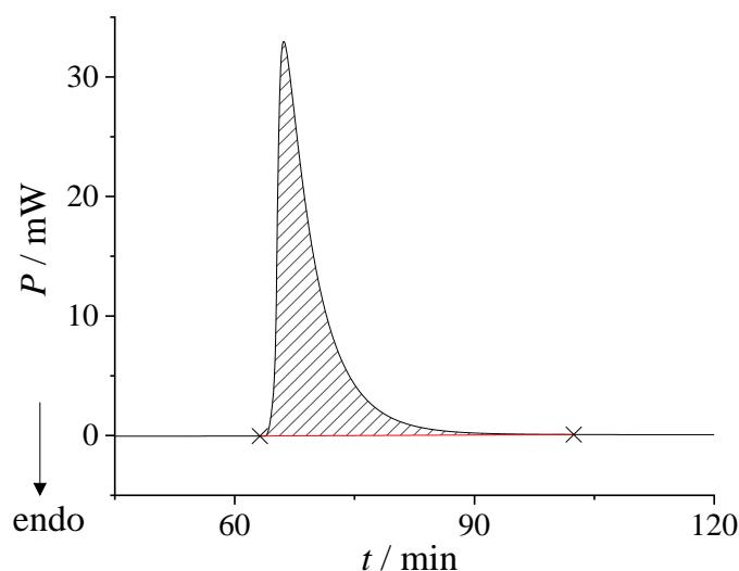
**Slika 61.** Termogram procesa kokristalizacije metastabilne tekućine benzofenona i difenilamina, u molarnom omjeru ( $n(\text{Bzp}) : n(\text{Dpa}) = 1 : 1$ ). Reakcija je provedena u Setaram-Calvetovom kalorimetru pri  $25 {}^\circ\text{C}$ .
