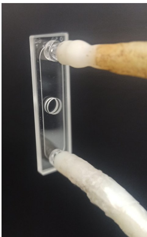
Slika 3.5: Protočna kiveta optičkog puta 0.5mm korištena u mjerenjima.
