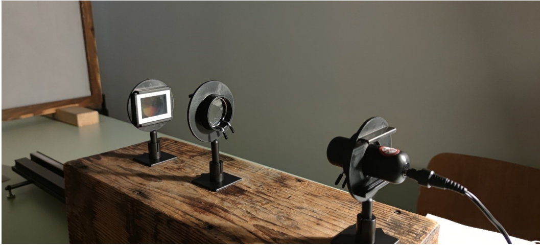
Slika 5.4: Postav pokusa za rasap bijele svjetlosti na optičkoj rešetki
