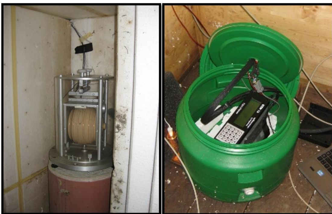
Slika 1.4 – Lijevo: Ovjješeni ( engl. suspended ) DIDD senzor koji mjeri na V-pilaru u variometarskoj kući. Oko senzora je postavljena izolacijska kutija kako bi se osigurala bolja temperaturna stabilnost. Desno: Elektronička jedinica DIDD magnetometra (GSM-19FD).
