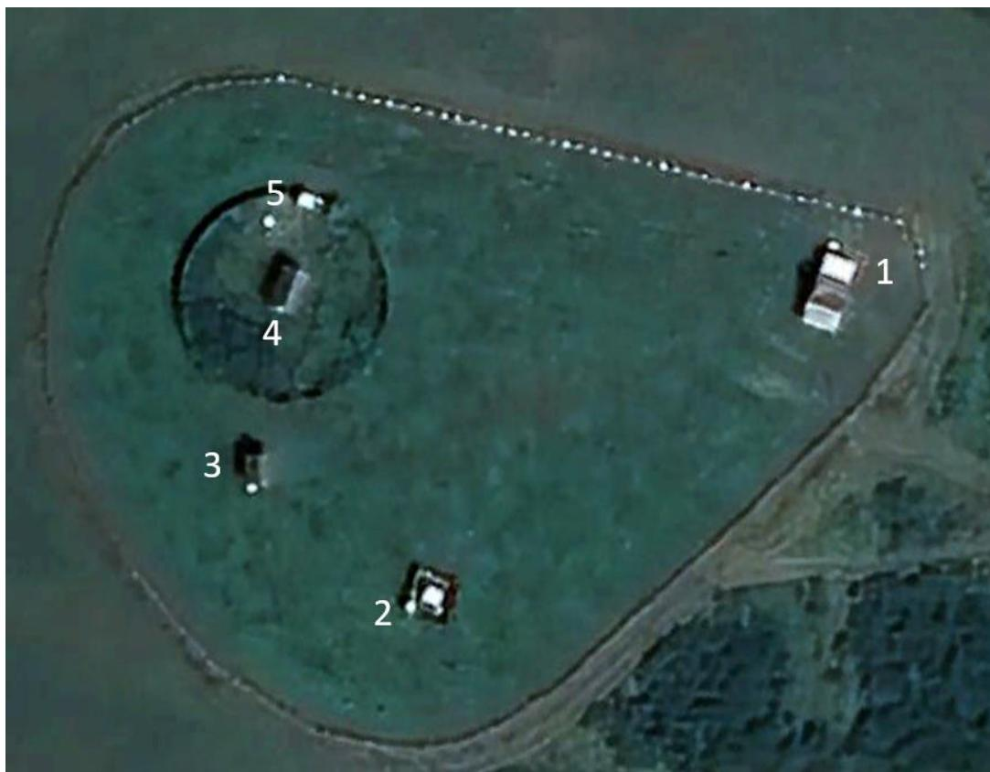
Slika 1.2 – Pet objekata LON opservatorija: 1) Kontrolna kuća, 2) Lokacija magnetometra LEMI-18, 3) referentna lokacija Opservatorija gdje se nalaze DIM i PPM magnetometar, 4) lokacija DIDD magnetometra, 5) lokacija magnetometra LEMI-35. (Podloga slike je preuzeta s „Google Earth“ aplikacije).
