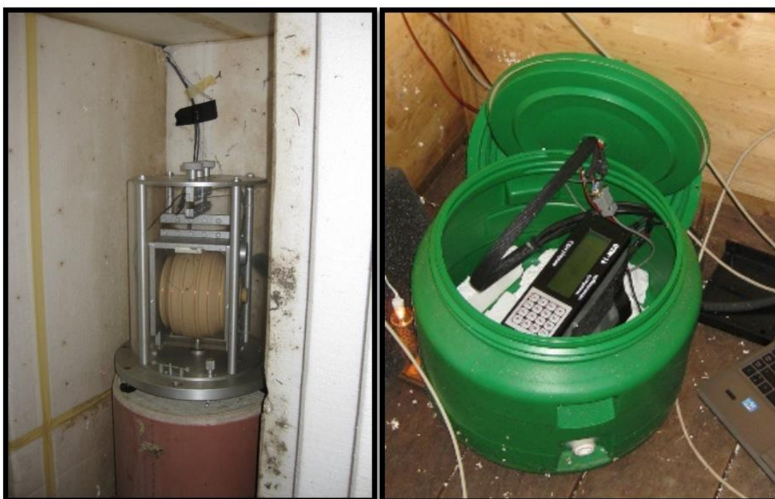
Slika 1.4 – Lijevo: Ovješeni ( engl. suspended ) DIDD senzor koji mjeri na V-pilaru u variometarskoj kući. Oko senzora je postavljena izolacijska kutija kako bi se osigurala bolja temperaturna stabilnost. Desno: Elektronička jedinica DIDD magnetometra (GSM-19FD).
