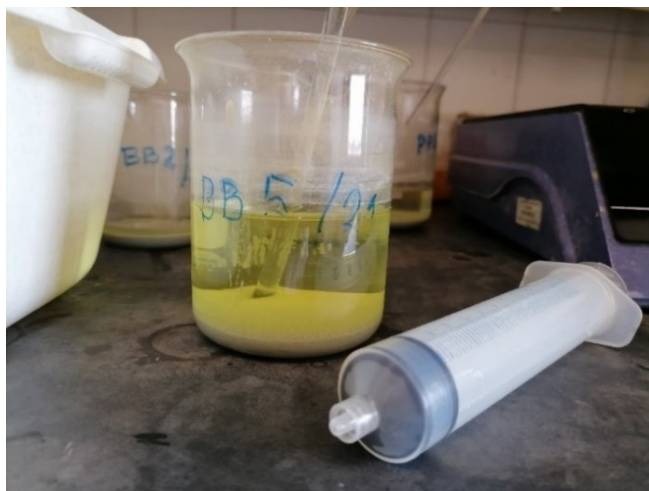
Slika 14: Uzorak BB5 nakon dodavanja Tammovog reagensa
