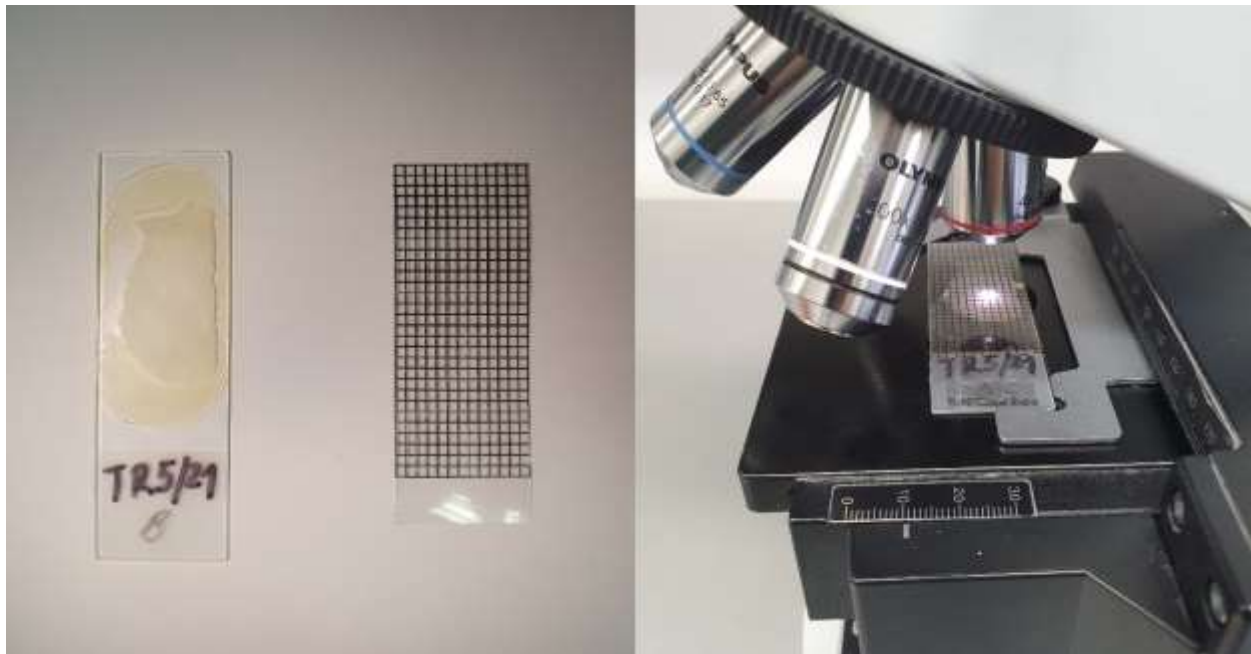
Slika 7. Mikroskopski izbrusak i plastična folija s mrežom kvadrata (lijevi dio slike). Provedba metode točkastog brojanja (desni dio slike).
