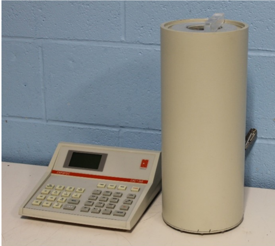
Slika 3.2: Mjerilo aktivnosti radioaktivnog uzorka Capintec 15R. (Slika je preuzeta iz [9].)
