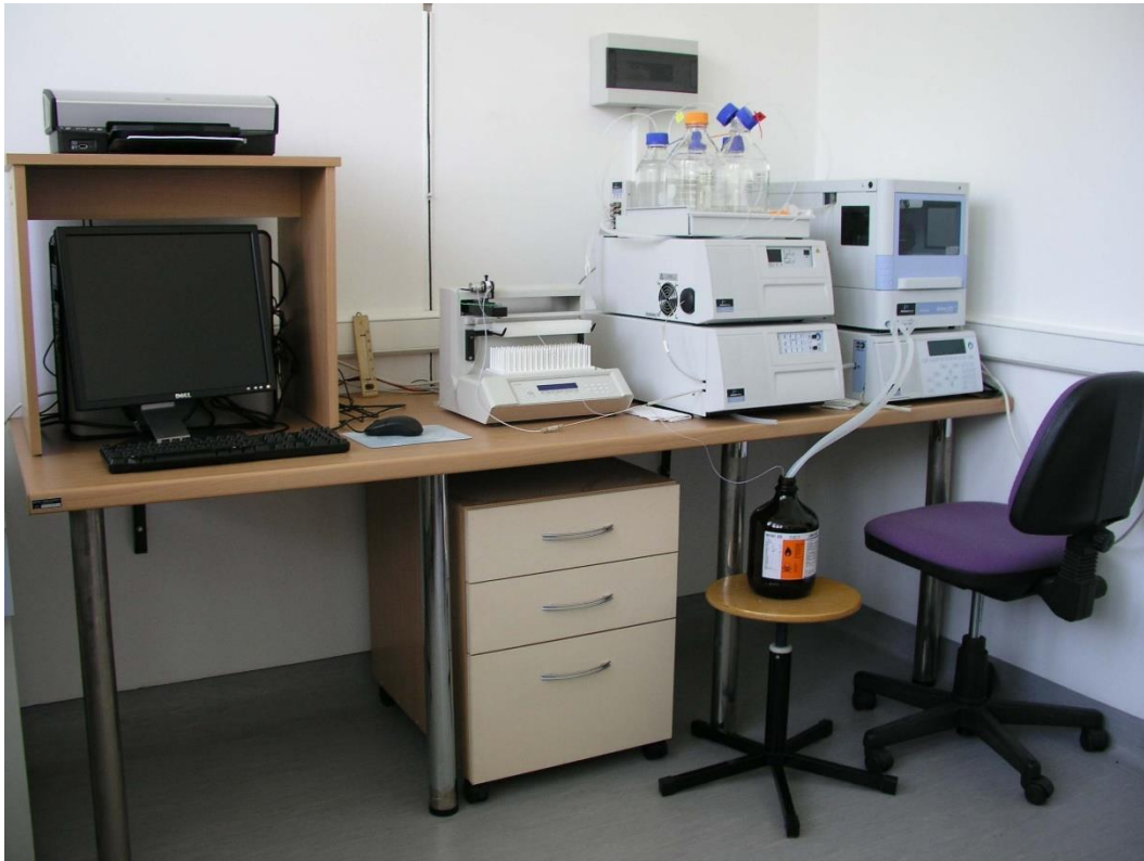
SLIKA 9. HPLC sustav Perkin Elmer, serija 200 sa kolonom Superdex™ 200 10/300 GL (GE Healthcare Biosciences).
