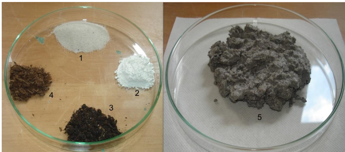
SLIKA 4. Medij za izlaganje: 1 - kvarcni pijesak; 2 - kaolinska glina; 3 - crni treset; 4 - bijeli treset; 5 - sastojci pomiješani s vodom
