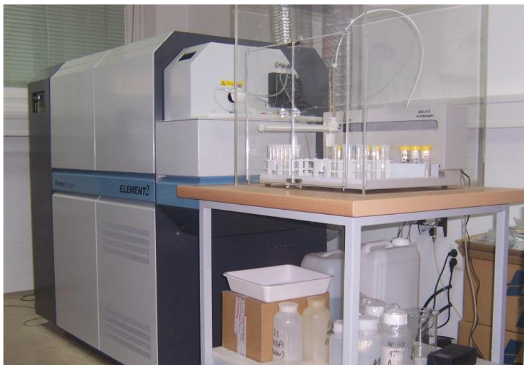
SLIKA 11. Maseni spektrometar visokog razlučivanja s induktivno spregnutom plazmom (HR ICP-MS) (Thermo Finnigan, Bremen, Njemačka) povezan sa automatskim dodavačem uzorka ASX 510 (CETAC, SAD).
