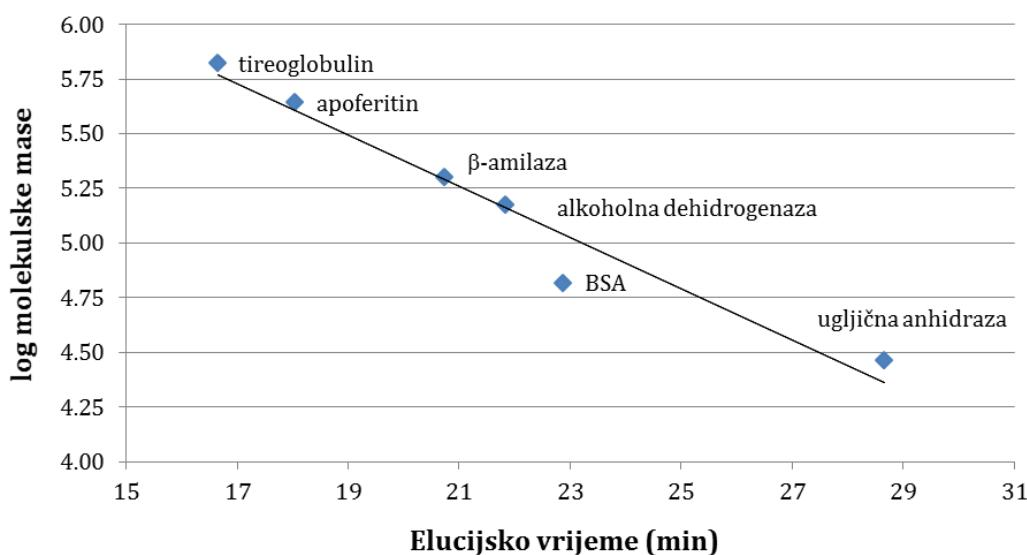
**SLIKA 10.** Kalibracijski pravac prema kojem je izračunata približna molekulska masa liganda koji vežu metale u citosolu tkiva gujavica. Prikazana je linearna ovisnost elucijskog volumena o logaritmu molekulske mase primjenjenih proteinskih standarda.
